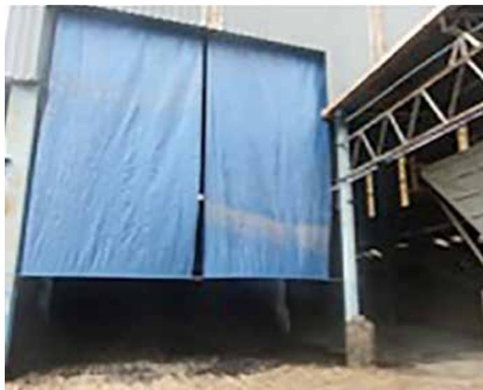
**FIGURA 14:** DEPÓSITO ADEQUADO PARA ARMAZENAMENTO DE PÓ DE BALÃO E LAMA DE ALTO FORNO.
