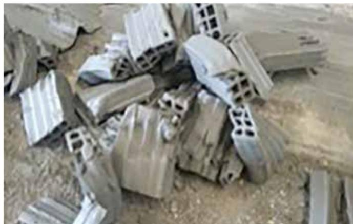
**FIGURA 11:** MATERIAL CRU NÃO CONFORME.
