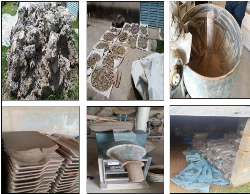
Figura 12: Etapas do processo da preparação da massa de argila.
