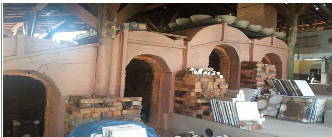
Figura 13: Forno Noborigama utilizado para a queima de produtos utilitários fabricados pela cerâmica 2C.
