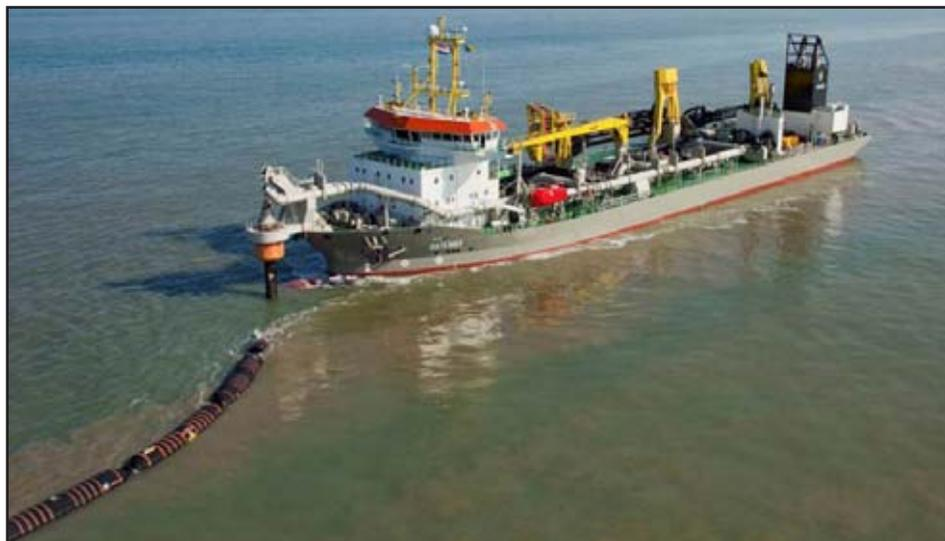
Figura 8. Ilustração de uma draga auto-transportadora com sistema de bombeamento conectado a uma tubulação. Fonte: Google Imagens.
