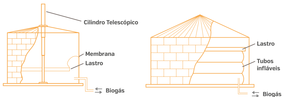
Figura 19: Gasômetro de membrana com lastro [esq.] e gasômetro de tubos infláveis com lastro [dir.]
