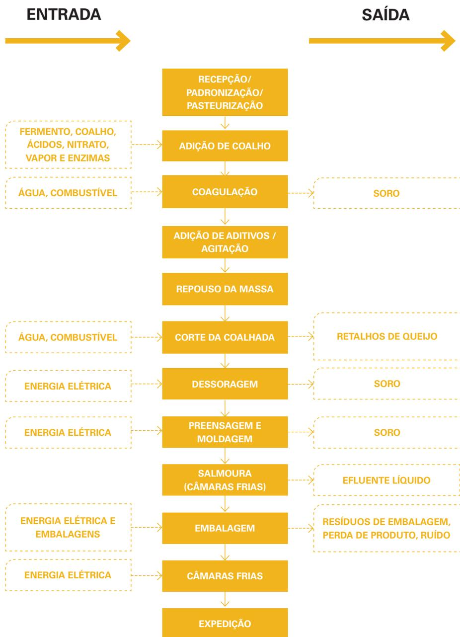
**Figura 7** - Fluxograma da fabricação de queijos | Fonte: Autores, 2014
