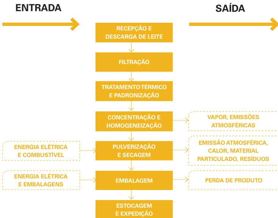
**Figura 14** - Fluxograma da fabricação de leite em pó |Fonte: Autores, 2014
