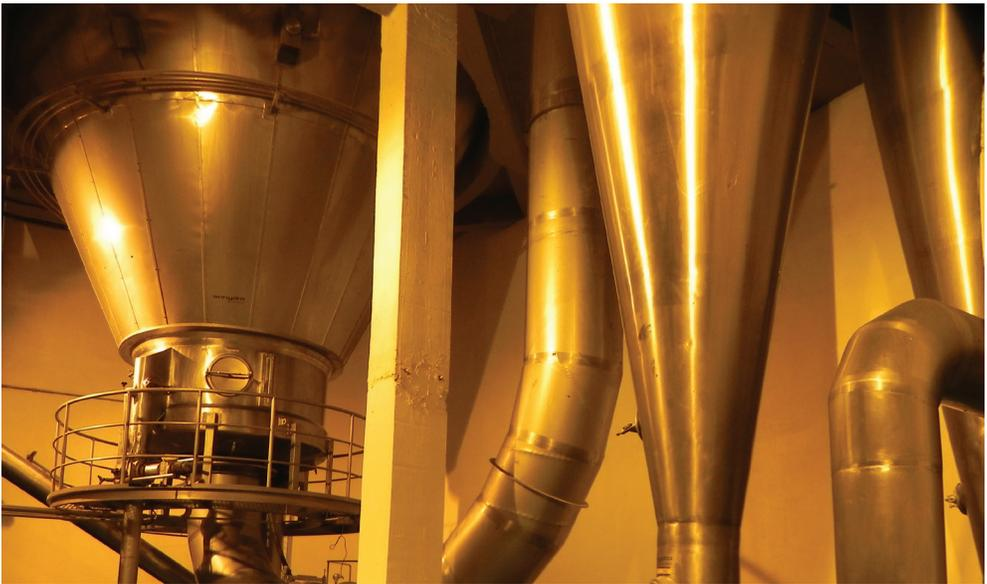
**Figura 17** – Processo de Secagem do Soro | Fonte: Autores, 2014
