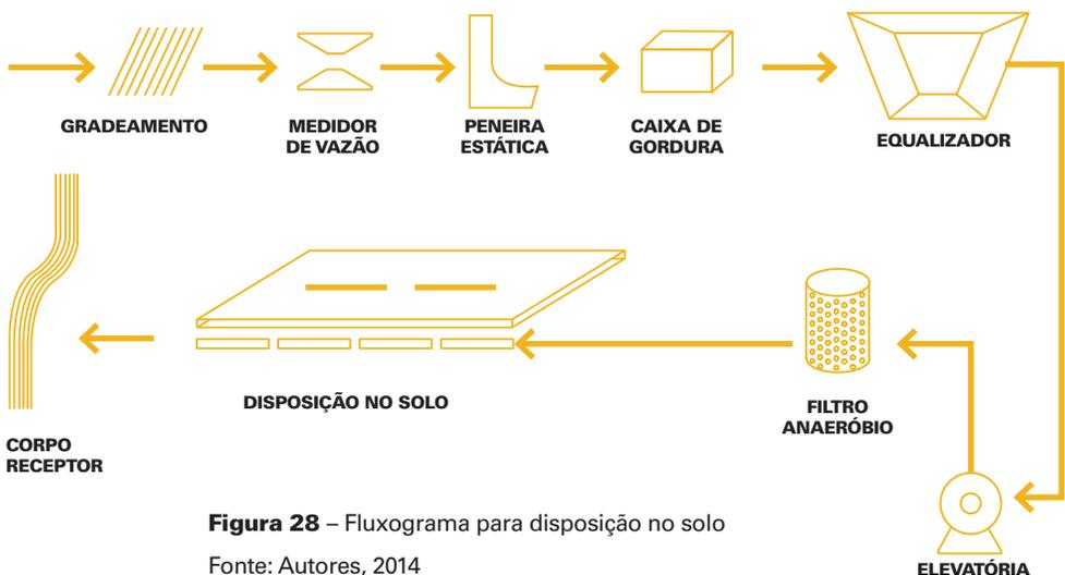
**Figura 28** – Fluxograma para disposição no solo
