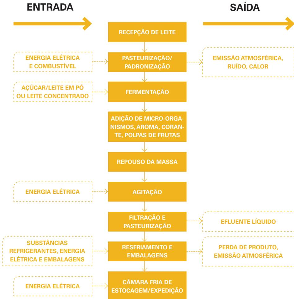
**Figura 13** – Fluxograma da fabricação de iogurtes | Fonte: Autores, 2014
