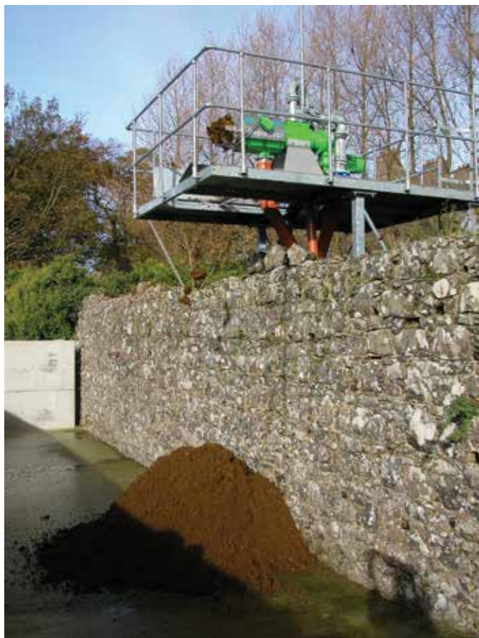
Figura 40 – Extrusora para separação sólido-líquido do material digerido de uma planta de biogás. Fonte: BAUER - 2, 2015.
