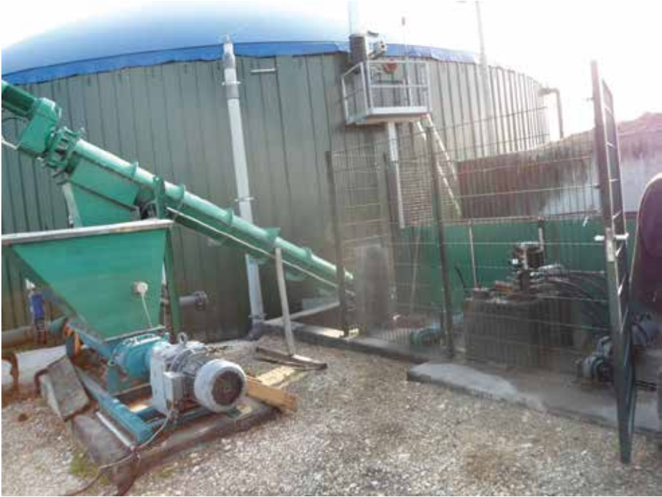
Figura 5 – Sistema de introdução de substratos sólidos utilizados em um digestor de mistura completa. Fonte: Arquivo Methanum.
