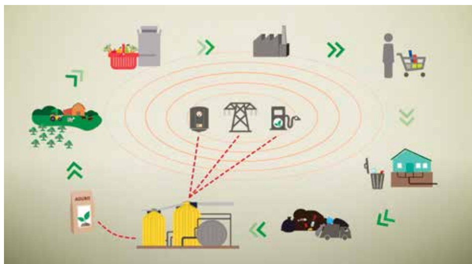
Figura 1 – Ciclo de geração e utilização do biogás. Fonte: MCIDADES 1, 2015.
