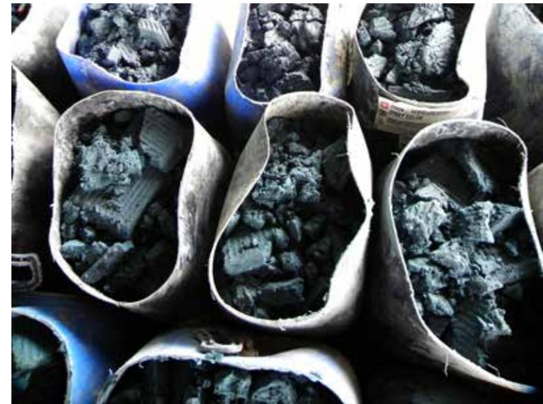
Figura 20 - Lodo proveniente da ETE, após a secagem | Fonte: Autores, 2014
