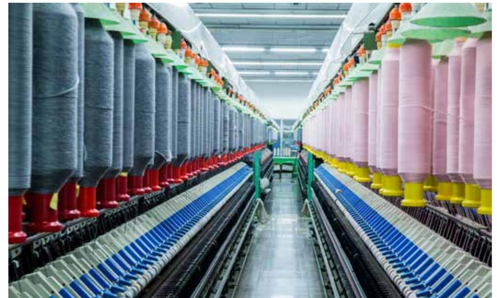
Figura 05 – Processo de Urdimento na Preparação para Tecelagem | Fonte: Autores, 2014
