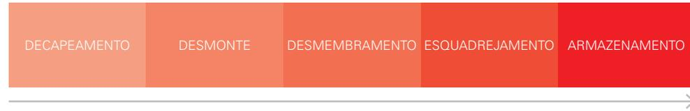
**Figura 8** - Fluxograma da extração do granito
